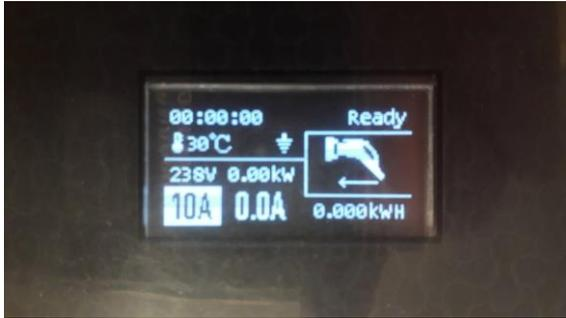
Das Gerät stellt den Wert, der vorher verwendeten Stromstärke ein, sobald das Gerät mit dem Stromnetz verbunden ist.
